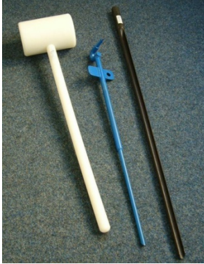
Pürckhauer Bohrstock mit Kunststoffhammer und Ziehgerät.
